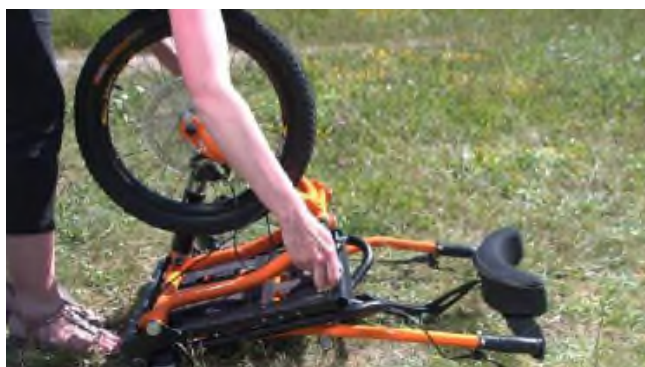
3 : Håll hjulet på plats, tryck igenom axeln och säkra den med låsstiftet
