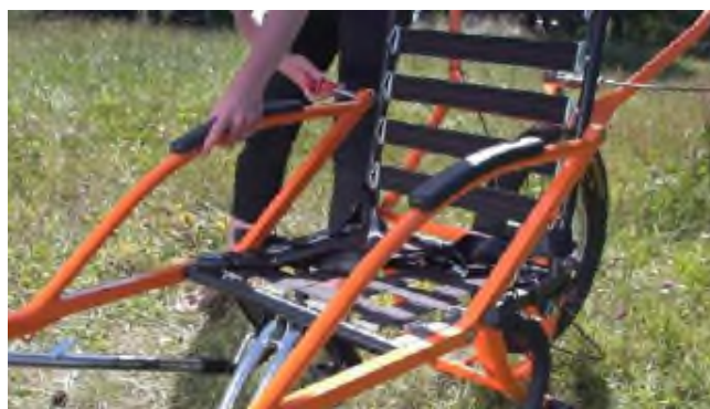
12 : Skruva fast armstödet mot sätet. Drag åt skruvarna ordentligt. Upprepa steg 11 och 12 på andra sidan.
