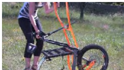
10 : Håll in det lilla handtaget och vik upp lyftarmarna. Fäll upp ryggstödet tills lyftarmarna får kontakt med hjulet.
