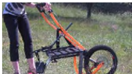
10 : Håll in det lilla handtaget och vik upp lyftarmarna. Fäll upp ryggstödet tills lyftarmarna får kontakt med hjulet.
