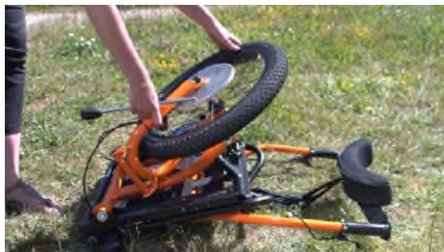
2 : Ta bort axeln och låsstiftet och vrid hjulet
