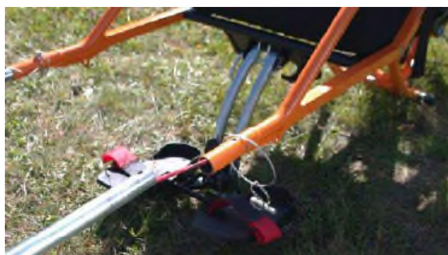
16 : Fäll ut lyftarmarna och tryck försiktigt in dem i rören.
