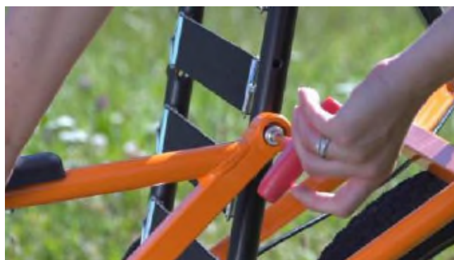
11 : Skruva fast armstödet mot ryggstödet.
