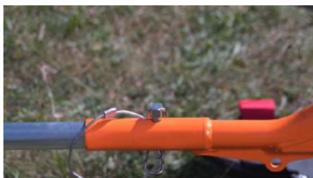
17 : Lås fast lyftarmarna med stift och bygel.
