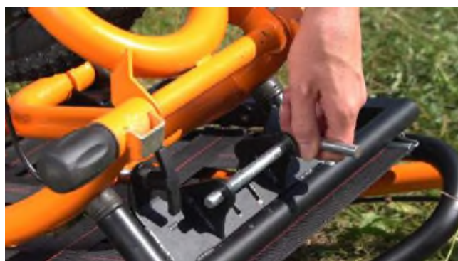
4 : Ta bort fotstödet låsstift och axel
