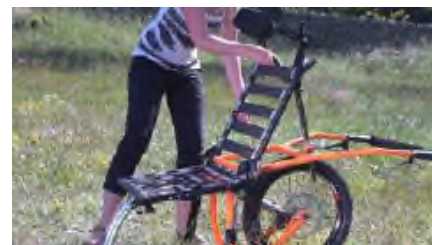
10 : Håll in det lilla handtaget och vik upp lyftarmarna. Fäll upp ryggstödet tills lyftarmarna får kontakt med hjulet.
